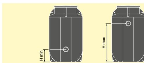
**Per la corretta predisposizione da parte del costruttore, al momento dell'ordine è necessario specificare la quota della tubazione di ingresso**
