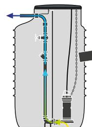
Tubazione di **uscita** in polietilene (scarico reflui)
