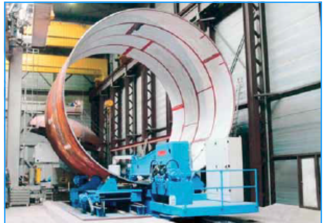
Ein Beispiel für Rohre, die von Häusler-Maschinen hergestellt wurden
